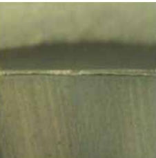
YG X5070 (Общая длина фрезерования : 540м)
