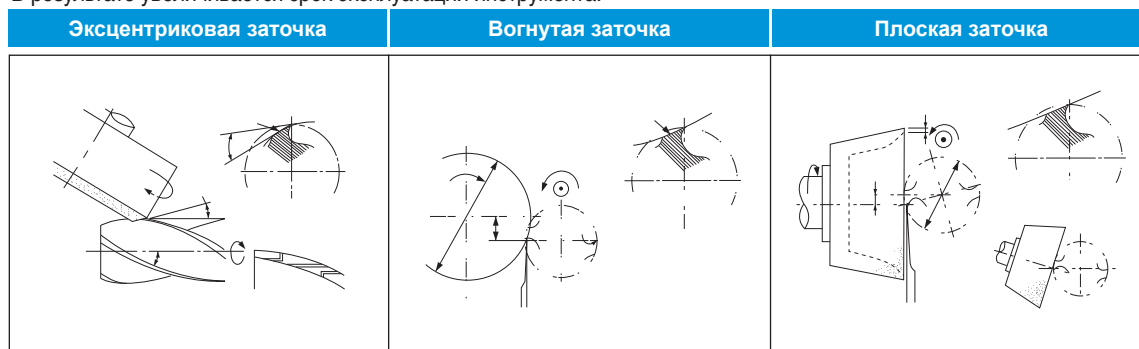
Рис. 3. Три способа заточки главного заднего угла
