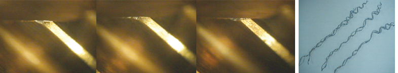
YG-1 (Нарезание резьбы в 490 отверстиях) - Спираль
