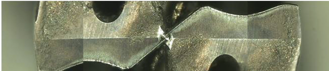
Сверло производителя А (после 546 отверстий)
