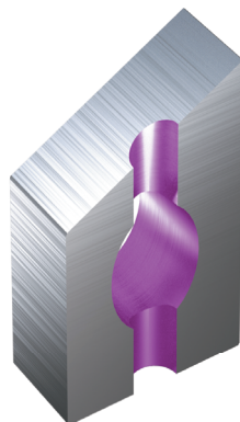
Сверление пересекающихся отверстий
